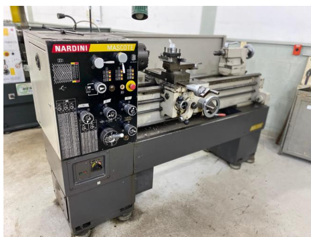
Figura 25 – Torno usado para usinagem dos discos
