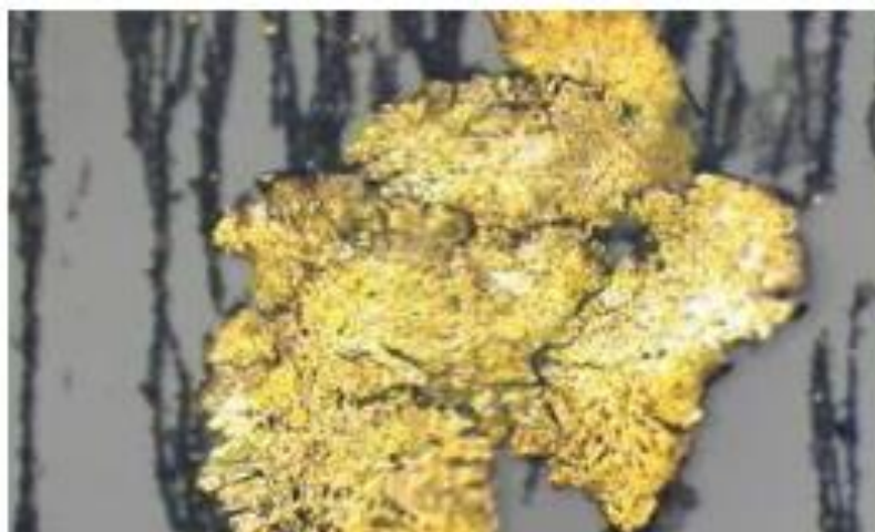
Figura 22 – Partículas de metais não ferrosos
