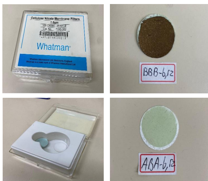
Figura 34 – Partículas filtradas na membrana celulosa
