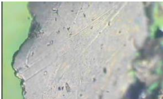
Figura 18 – Partícula de desgaste do rolamento
