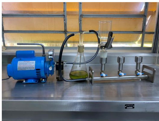
Figura 23 – Filtragem por membrana por médio da bomba de vácuo
