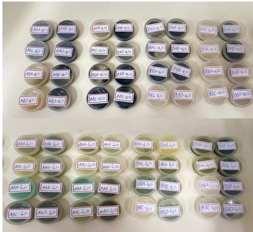
Figura 37 – Amostras para o PQA: a) F.F. nodular e b) bronze TM-23
