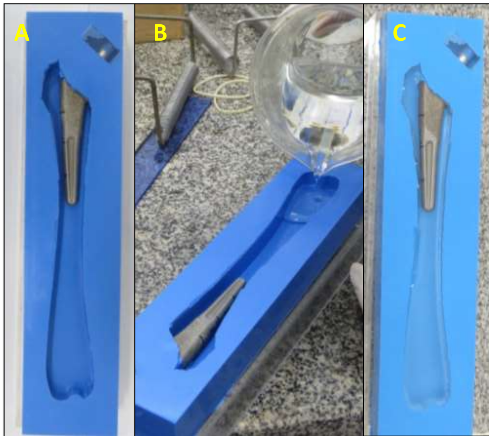
Figura 14. Imagens fotográficas das etapas de confecção dos corpos de prova em resina fotoelástica. (A) Molde em silicone dos corpos de prova em alinhamento neutro. (B) Haste femoral posicionada em alinhamento neutro no interior do molde, iniciando o preenchimento com a resina fotoelástica. (C) Molde contendo a haste femoral e aparato de posicionamento da porção proximal da haste, totalmente preenchido pela resina fotoelástica.
