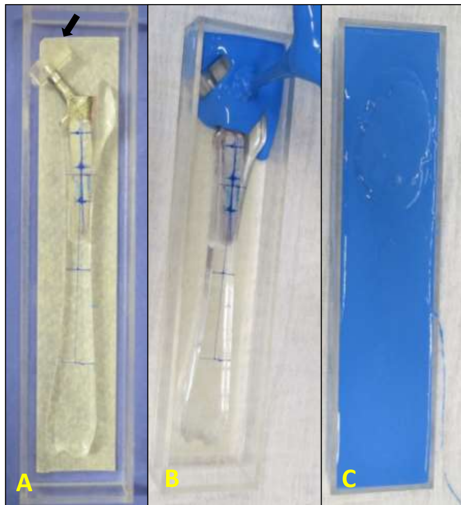
Figura 13. Imagens fotográficas da preparação dos moldes em silicone azul. (A) Posicionamento do modelo femoral com a haste implantada e do dispositivo (seta) para posicionamento da parte proximal da haste no centro da caixa acrílica. (B) Preenchimento da caixa com a preparação de silicone azul e catalisador. (C) Caixa em acrílico após o preenchimento total, em processo de secagem.
