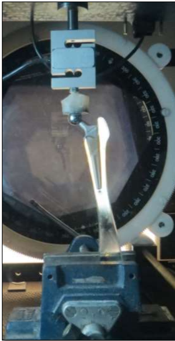
Figura 17. Imagem fotográfica mostrando o posicionamento do corpo de prova no quadro de carga da máquina de teste de material servohidráulico. Note o aparato semelhante a morsa na parte distal do corpo de prova, mantendo o varus distal e a cúpula acetabular adaptada para coaptação na cabeça femoral protética.
