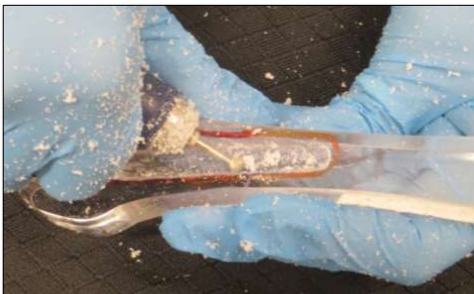
Figura 7. Imagem fotográfica evidenciando o desgaste realizado com auxílio de micromotor odontológico da região equivalente ao canal femoral proximal.
