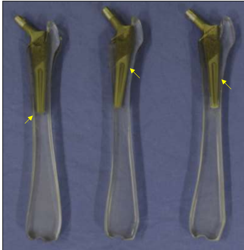
Figura 15. Imagem fotográfica da face caudal de exemplares dos corpos de prova em resina fotoelástica nos três diferentes alinhamentos: (A) neutro, (B) valgo e (C) varo. Note os pontos (setas) demarcados ao redor da haste, pontos pré-estabelecidos para mensuração da tensão interna (kPa).
