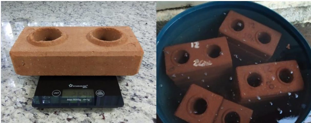
Figura 16 – Tijolo submetidos a ensaios de absorção, densidade e porosidade.
