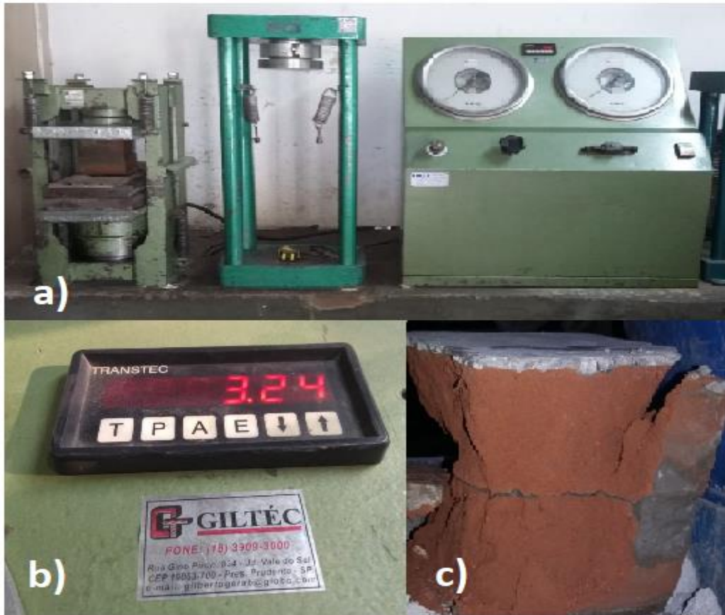
Figura 20 – a) Conjunto da máquina de compressão e o rompimento do tijolo; (b) carga em quilograma força (kgf) e (c) tijolo rompido.
