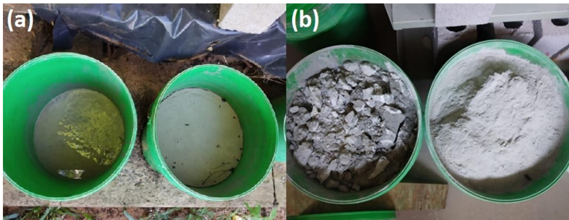
Figura 5 – (a) Resíduo de RPPO logo após coleta; (b) RPPO em processo de secagem e totalmente seco e peneirado.
