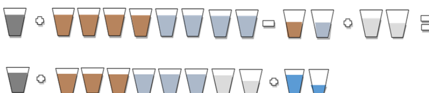
Figura 7 – Modelo Esquemático da produção dos tijolos de solo-resíduo-cimento 1:8
