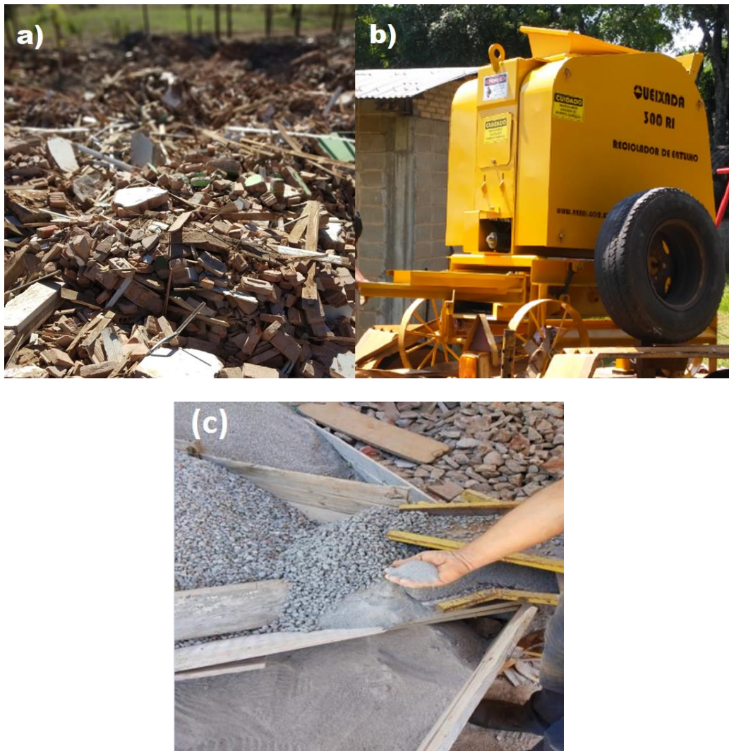
Figura 4 – (a) Depósito de RCC, (b) recicladora de RCC, (c) granulometrias disponíveis.
