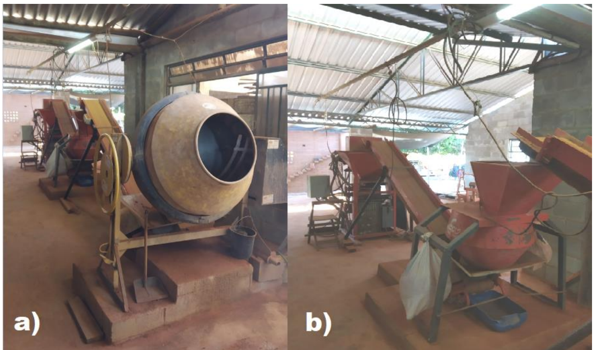
Figura 11 – Conjunto betoneira e peneira.
