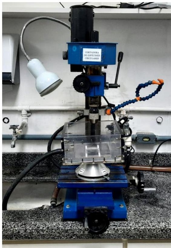
Figura 4: Equipamento cortador de amostras circulares.
