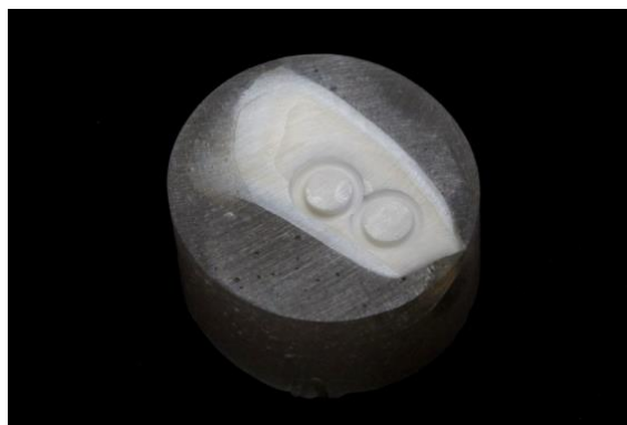
Figura 5: Secção da amostra após utilização da broca trefina.
