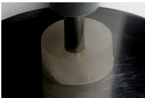
Figura 9: Amostra posicionada para análise em FTIR.
