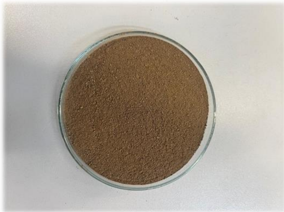
Figura 18 - Lodo de estação de tratamento de água após ser triturado em moinho.
