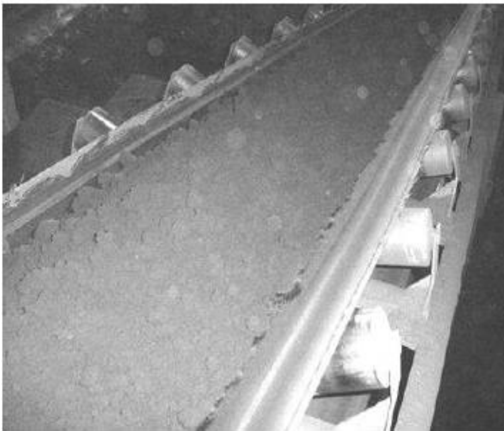
Figura 5 - Processo de desmoldagem das peças e areia com aditivos retornando para o processo de moldagem.
