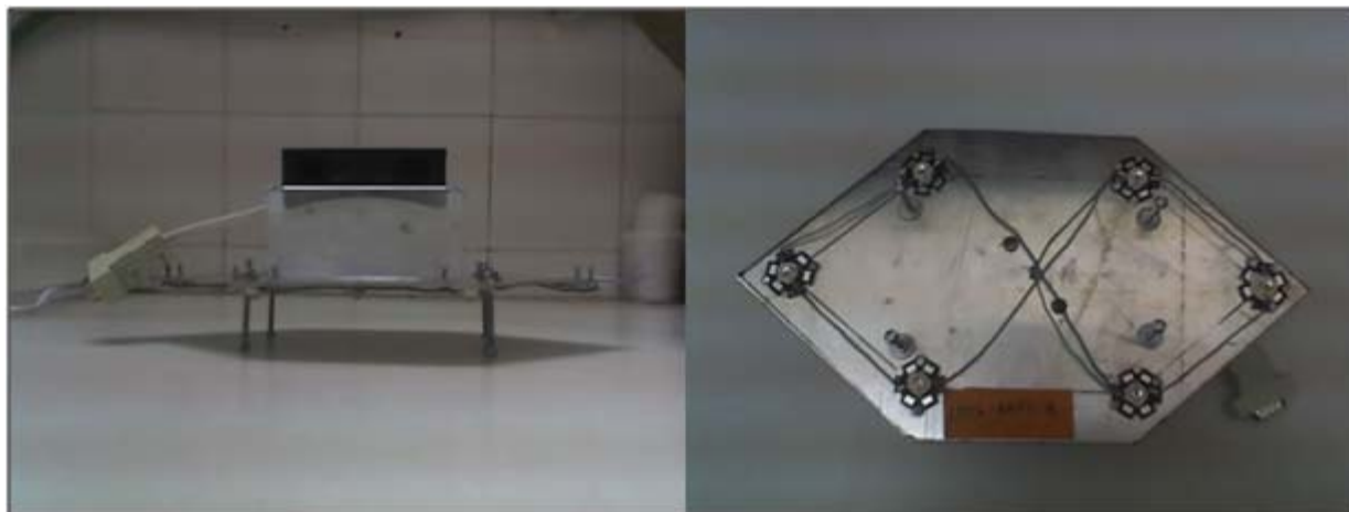
Figura 2. Vista lateral (foto esquerda) e vista inferior (foto direita) do equipamento para iluminação confeccionado para iluminação das soluções com azul de metileno.
