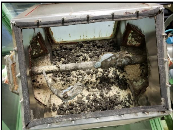
Figura 96 - Segunda batelada, co-compostagem de lodo de esgoto e bagaço de cana-de-açúcar
