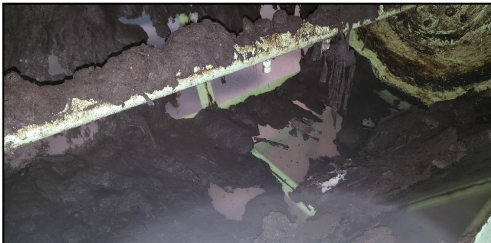
Figura 131 - Resíduos depositados no eixo e nas paredes do reator ao final da quinta batelada
