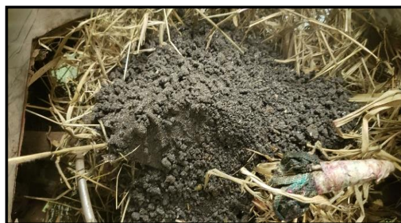
Figura 112 - Lodo de esgoto depositado junto aos demais resíduos para quarta batelada
