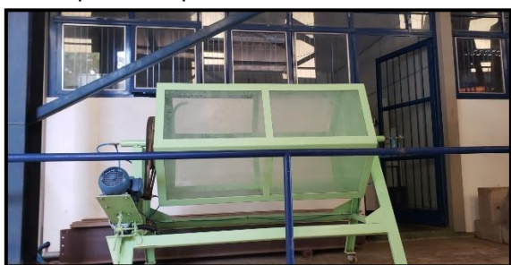
Figura 122 - Reator hermético rotativo com capacidade para 974,27cm 3 de resíduos
