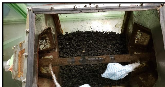
Figura 87 - Disposição do lodo e proteção da saída e entrada de ar para evitar entupimento
