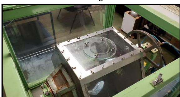
Figura 88 - Reator fechado para evitar entrada e saída de gases
