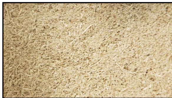
Figura 109 - Resíduos de bagaço de cana-de-açúcar utilizados na quarta batelada.
