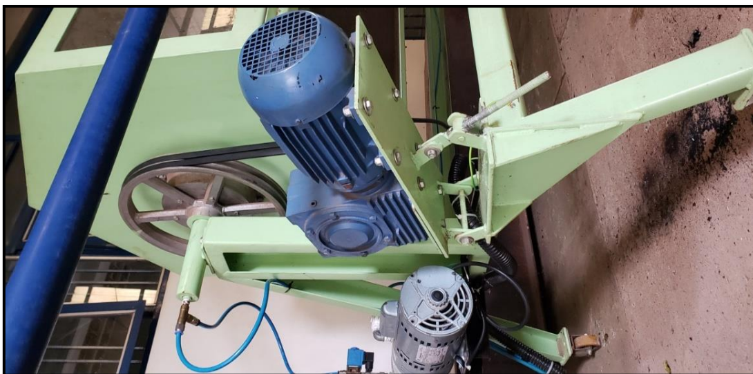
Figura 129 - Substituição e alinhamento das correias do motor
