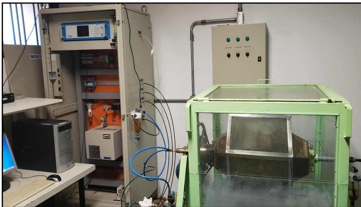
Figura 47 - Estrutura do processo de experimentos de compostagem formada basicamente por: tambor rotativo, analisador de gases e aquisição de dados
