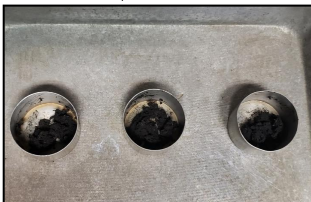
Figura 79 - Finalização do processo de avaliação da umidade, após 24h em estufa a 105^{\circ}\text{C}
