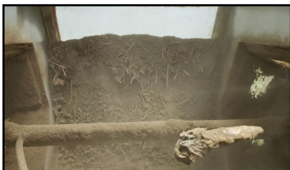
Figura 104 - Resultado da terceira batelada, apresentando poeira no interior do reator
