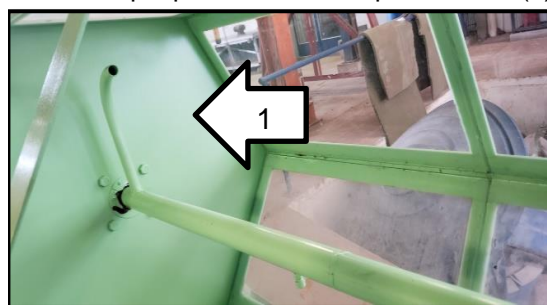
Figura 56 - Interior do tambor rotativo, destaque para saída de ar para análise(1)
