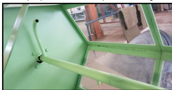
Figura 123 - Disposição interna do reator com destaque para saída de ar para análise gasosa.
