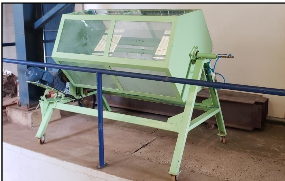
Figura 52 - Tambor rotativo hermético com capacidade para 974,3cm 3
