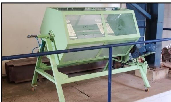
Figura 53 - Visão geral do reator de compostagem de grande porte
