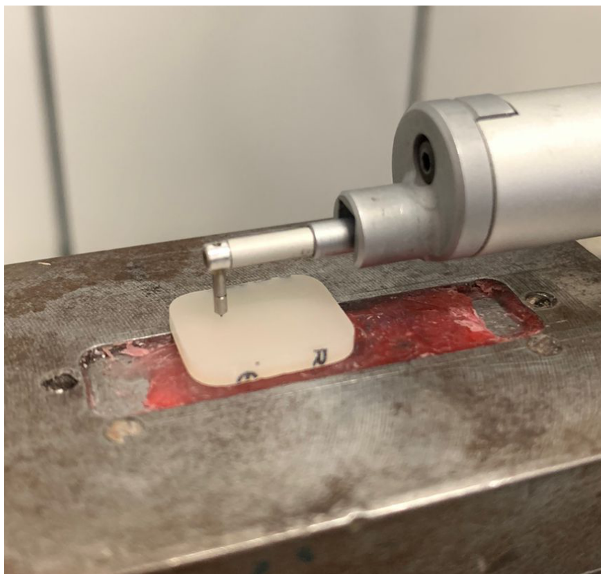
Figura 9 – Perfilômetro de contato medindo rugosidade do espécime
