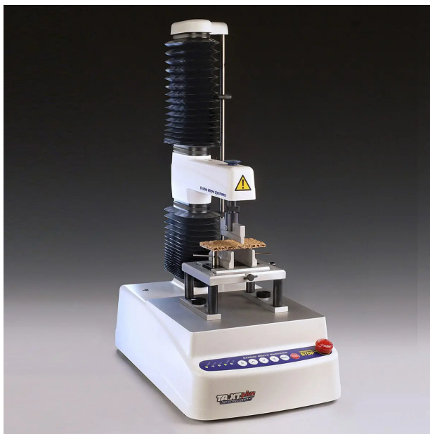
Figura 5 –Equipamento TA-XTplus utilizado para análise de dureza e adesão dos grãos de café
