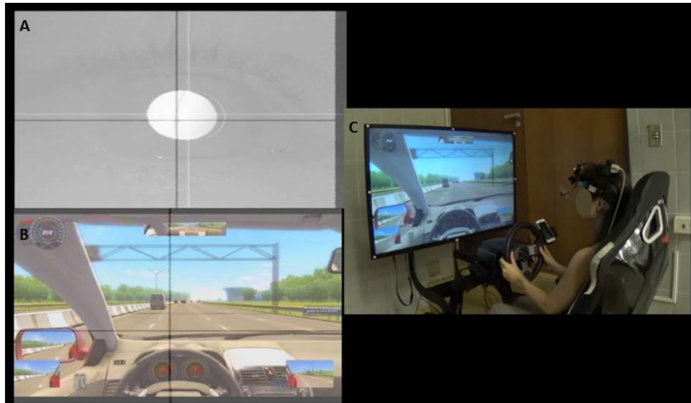
FIGURA 1 – Amostras de imagens de vídeos utilizadas durante a coleta de dados: (A) imagem do olho e as coordenadas do centro da pupila e da reflexão na córnea, (B) imagem das coordenadas da linha do olhar na cana do simulador, e (C) imagem de câmera externa mostrando o ambiente da coleta.
