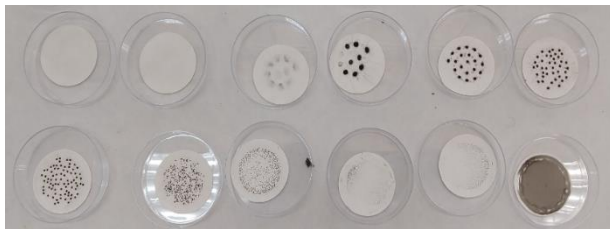
Figura 3. Amostra 1 com velocidade de 8 m/s e sem Venturi.
