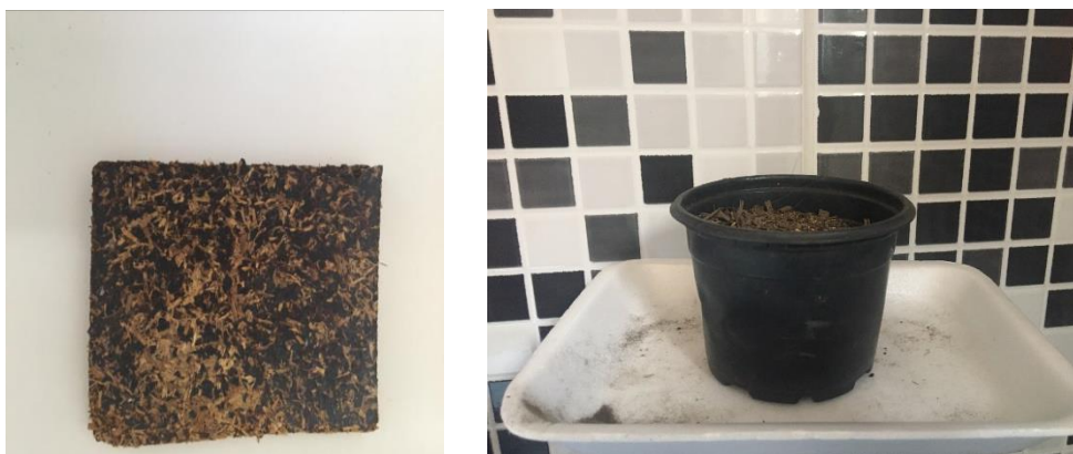
Figura 17: Ensaio de biodegradação em solo
