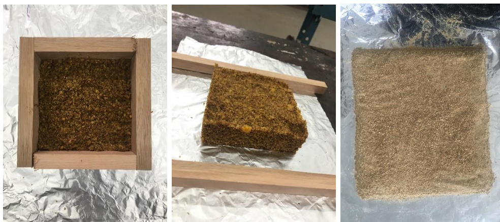
Figura 11: Processo de formação do compósito úmido e seco
