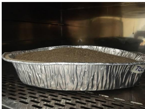
Figura 6: Partículas de bambu em processo de secagem em estufa
