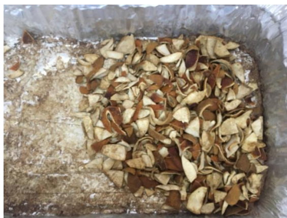
Figura 8: Material após secagem em estufa por 48h
