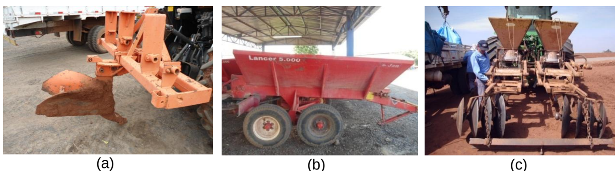
FIGURA 3. Equipamentos utilizados no sistema convencional: a) Sulcador utilizado na abertura do sulco b) Distribuidor de calcário; c) Cultivador utilizado no fechamento e nivelamento do sulco.
