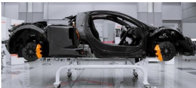
Figura 4 - CFRP empregado na estrutura do modelo monocoque McLaren P1. Fonte: (Jin et al. , 2021)
