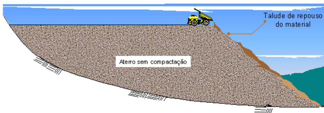
Figura 7 - Desenho esquemático da construção por ponta de aterro.
