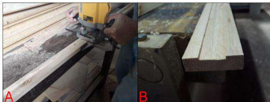
Figura 33 – Usinagem das peças: A: Usinagem do entalho e B: Entalho finalizada
