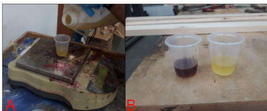
Figura 34 – Pesagem das componentes da resina: A: Componente sendo pesada e B: Pesagem finalizada para ambas componentes
