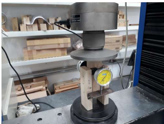
Figura 39 – Ensaio mecânico de cisalhamento ( Double Shear )
