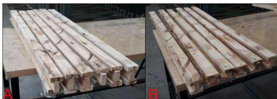
Figura 36 – Vigas coladas confeccionadas
