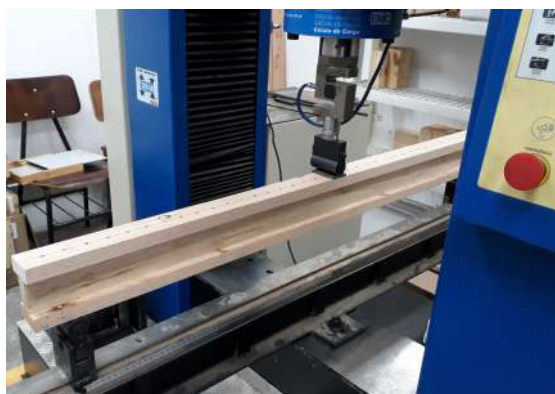
Figura 40 – Ensaio mecânico de flexão estática com carga centrada no meio do vão
