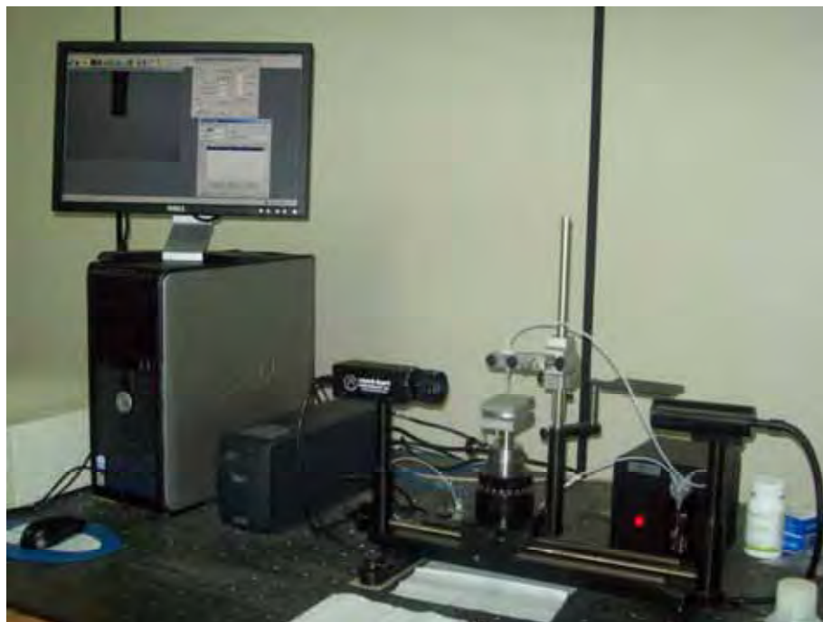
Figura 28 – Sistema utilizado para medição da molhabilidade dos filmes.
