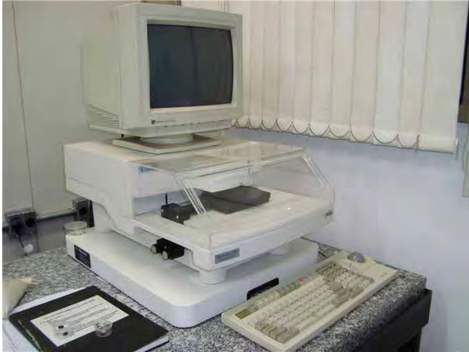
Figura 24 – Perfilômetro utilizado para medidas de espessuras dos filmes poliméricos com e sem implantação iônica.
