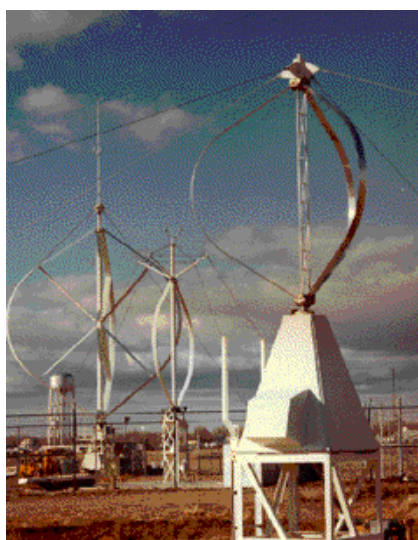
Figura 5. Exemplo da turbina idealizada por D. G. Darrieus. (BHATTI et al., 1997)
