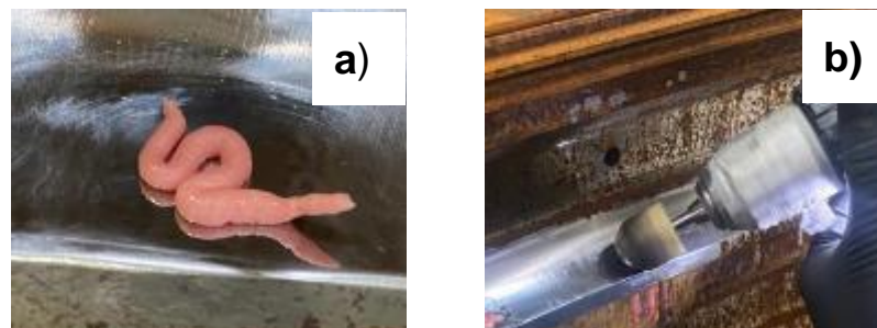
Figura 22 - Pasta de diamante aplicada (a) e polimento da superfície (b)
