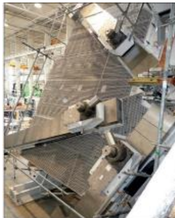
Figura 15 - Máquina de Têmpera de indução eletromagnética para anéis de até 6 metros de diâmetros
