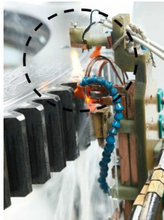
Figura 13 - Austenitização observado no indutor no momento do processo de têmpera por indução
