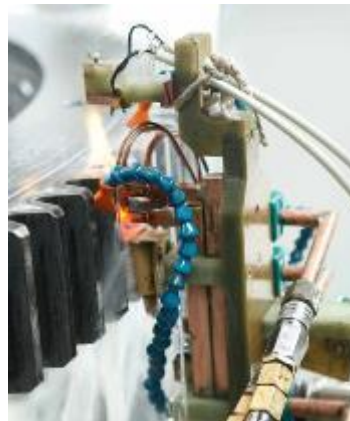
Figura 10 - Indutor para realizar a têmpera por indução de anéis.
