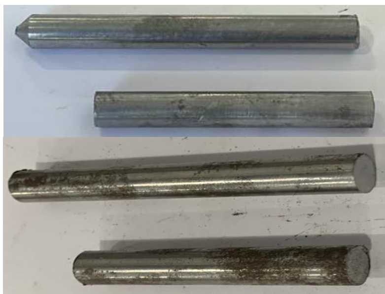
Figura 13 – Corpos de prova com as pontas usinadas
