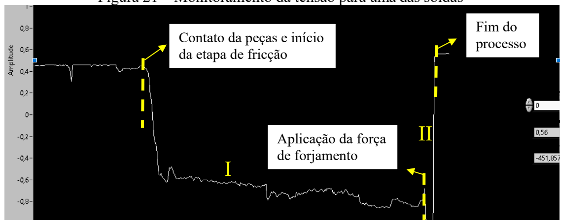
Figura 21 – Monitoramento da tensão para uma das soldas
