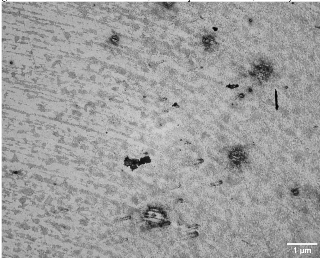
Figura 54 – Linhas de fluxo SAE 1020, solda de ponta cônica C2, lente objetiva 10X
