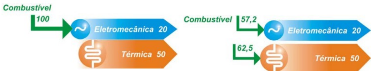
Figura 1. Comparação de geração de energia térmica e eletromecânica em separado (esquerda) vs. cogeração com produção térmica e elétrica em simultâneo (direita).
