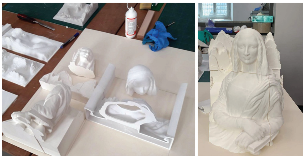
Figura 25 - Detalhe da impressão das peças em partes e montagem.
