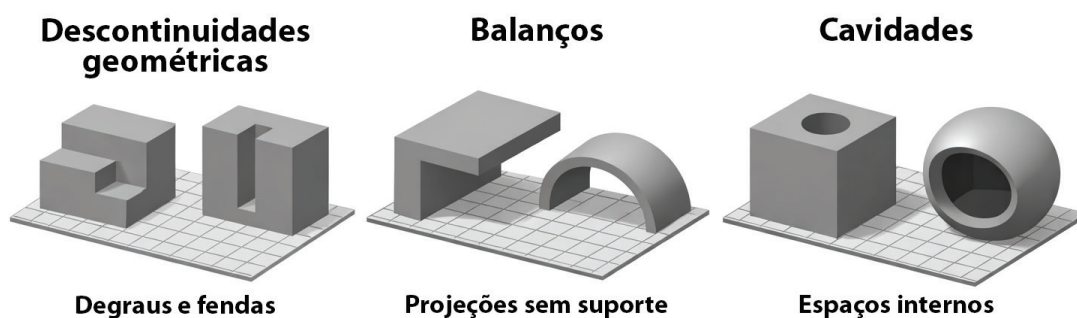
Figura 8 - Orientação de peças com balanços, cavidades ou descontinuidades e o uso de estruturas de suporte.
