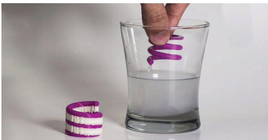
Figura 18 - Impressão de suportes do modelo utilizando filamento solúvel.
