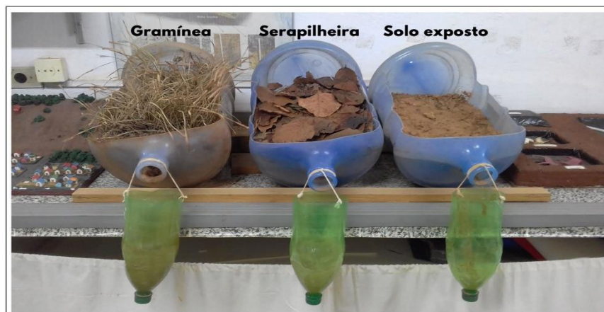
Figura 10: Experimento – Erosão hídrica.
