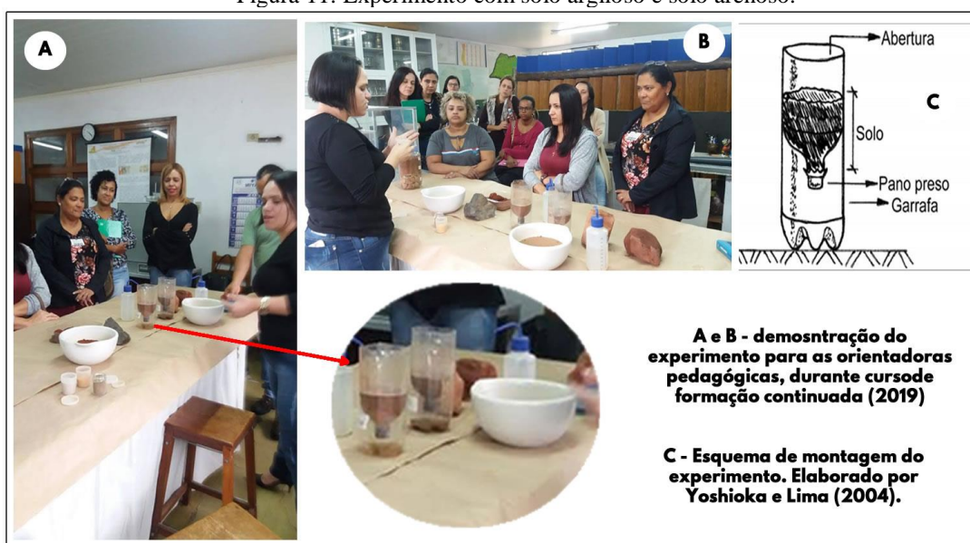
Figura 11: Experimento com solo argiloso e solo arenoso.
