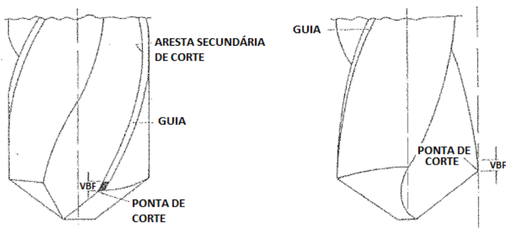
Figura 7 – Representação do desgaste VBF na aresta secundária de corte
