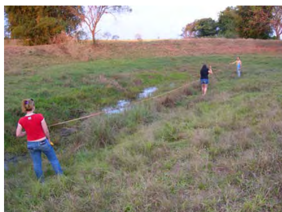
Ilustração 6: Medições para obtenção do volume do reservatório artificial presente na propriedade
