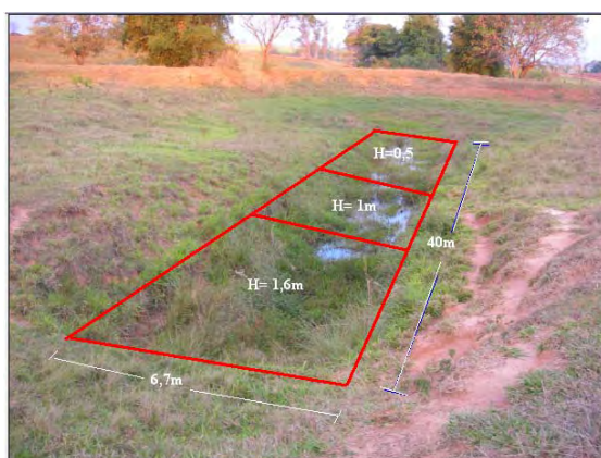
Ilustração 6: Medições para obtenção do volume do reservatório artificial presente na propriedade
