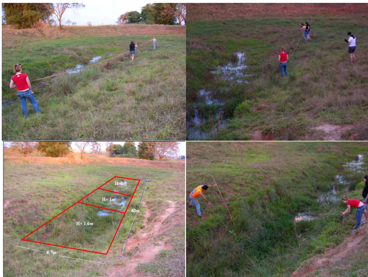
Figura 1: Medições realizadas no reservatório natural da propriedade de modo a dimensionar sua capacidade de armazenamento.
