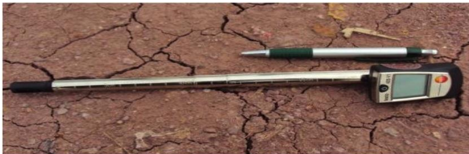
Figura 11: Termo-anemômetro digital portátil TESTO, modelo 405-V1
