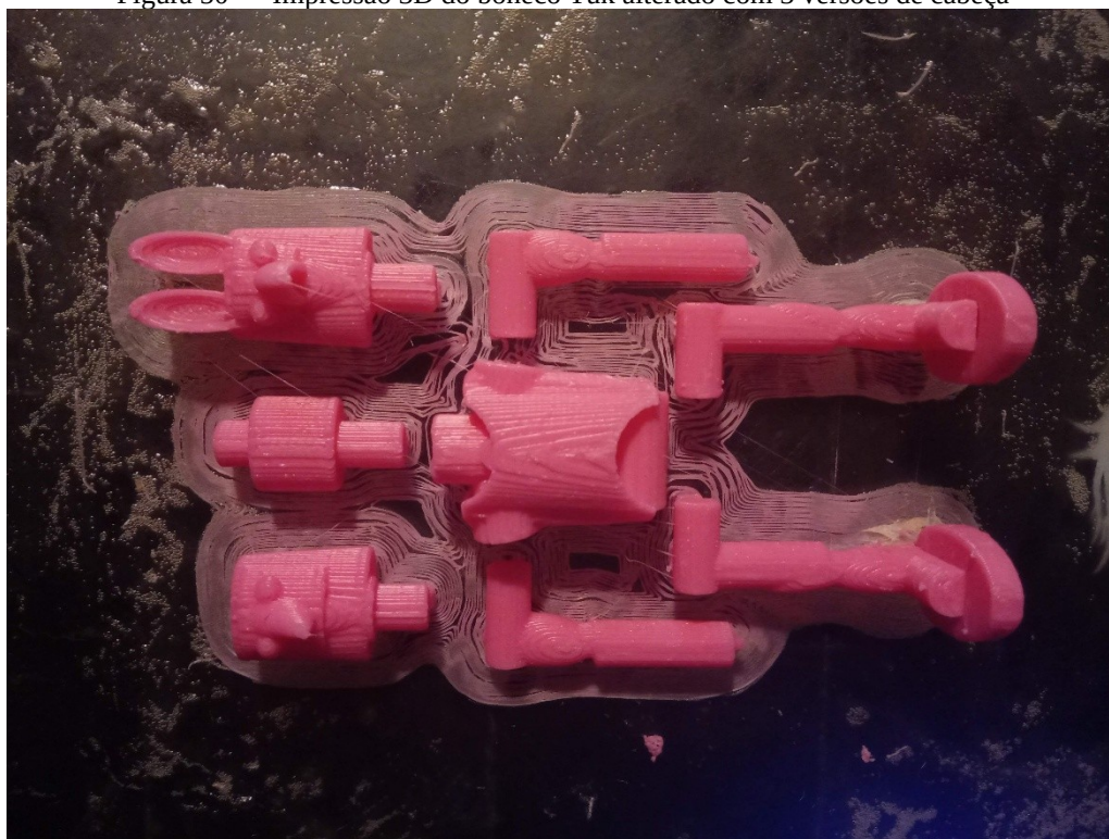
Figura 50 — Impressão 3D do boneco Tuk alterado com 3 versões de cabeça
