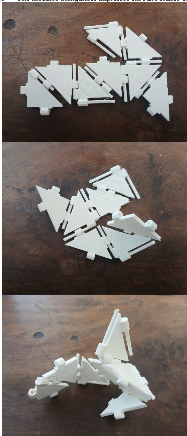
Figura 10 — Oito módulos triangulares impressos em PLA branco conectados
