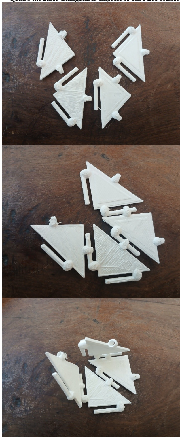
Figura 12 — Quatro módulos triangulares impressos em PLA branco conectados
