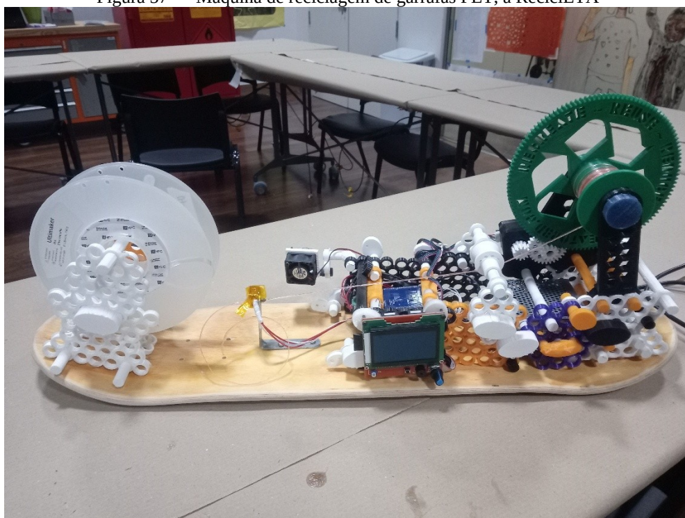
Figura 57 — Máquina de reciclagem de garrafas PET, a ReciclETA
