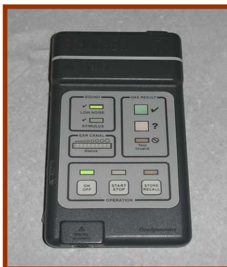
Figura 2. Equipamento de EOAETs - ECHOCHK, da Otodynamics Ltd, com os quadros iluminados indicando estar ligado.
