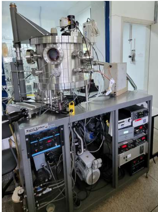
Figura 7 – Sputtering da marca Kurt J. Lesker Company utilizado para as deposições dos filmes de MoO x .
