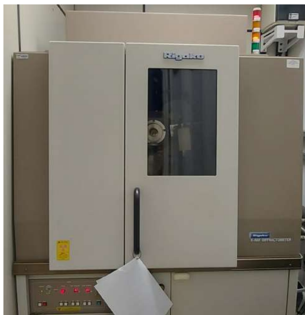
Figura 11 – Difratorômetro Rigaku, D/MAX-2100PC utilizado para as análises.
