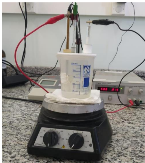
Figura 10 - Representação esquemática de uma célula eletrolítica usada durante a oxidação anódica.
