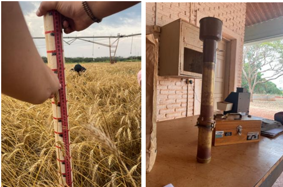
Figura 4. Avaliação da altura de plantas e Equipamento utilizado para determinação da massa hectolétrica
