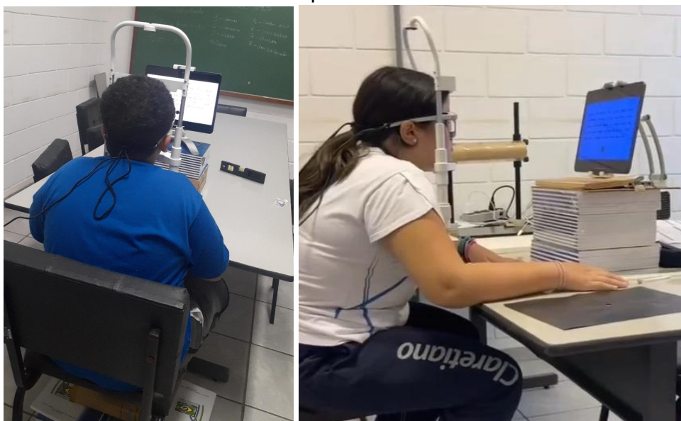
Figura 6 - Realização do teste de leitura utilizando o Eye Tracking Glasses com filtro azul aplicado à tela
