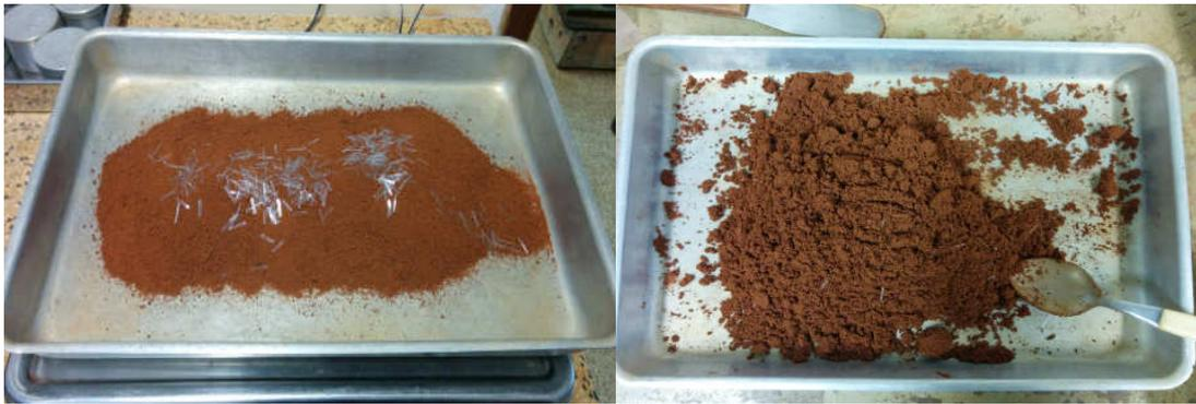
Em seguida foram realizados ensaios de compressão simples ou ensaios de resistência não confinada, segundo as recomendações da ABNT NBR 12770/1992. Para a avaliação da resistência não confinada, os solos foram moldados na umidade ótima do ensaio de Proctor Normal, ou seja, grau de compactação (GC) igual a 100%. Foram realizados ensaios com 3 corpos de prova para cada comprimento e respectivo teor de fibra:
