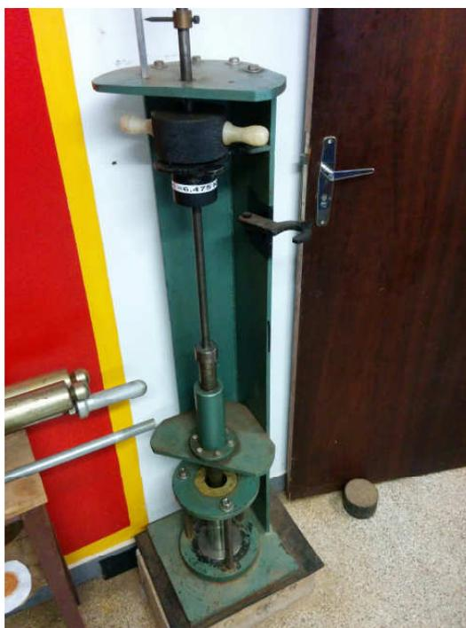
Figura 18: Prensa do ensaio de compressão simples.
