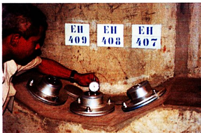
Figura 17 – Croquis mostrando roseta extensométrica (EH-407, 408 e 409).
