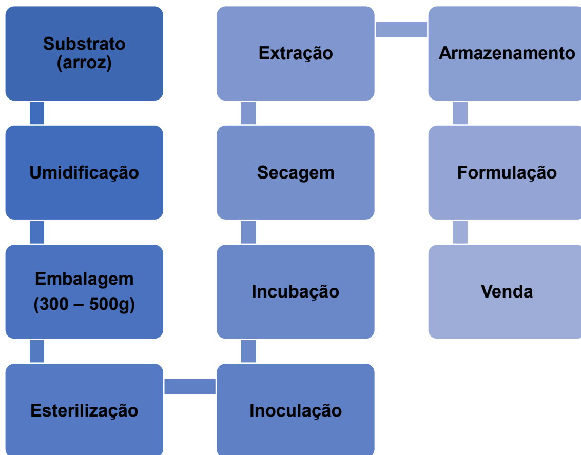
Figura 3.4. Fluxograma do processo de produção em sistema de CES estático dos esporos do fungo M. anisopliae .
