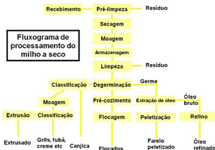
Figura 3.5. Fluxograma do processamento a seco do milho.
