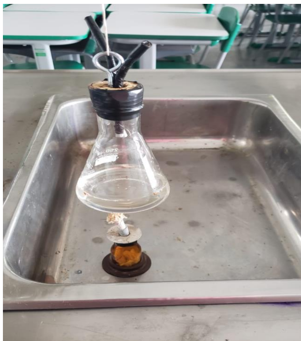
Figura 1: Experimento máquina de Herón
