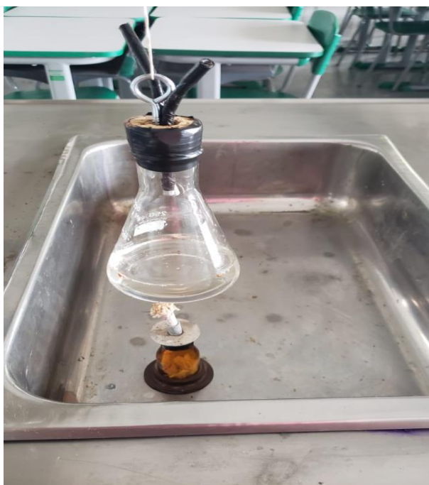
Figura 12 — Experimento máquina de Herón
