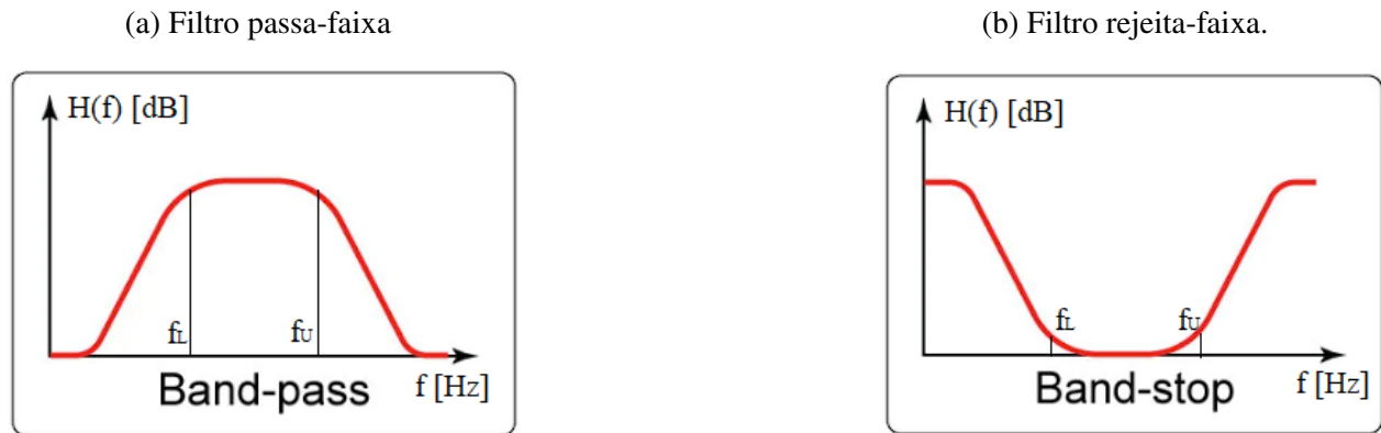
Figura 4 – Filtros passa-faixa e rejeita-faixa.
