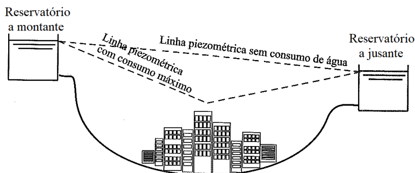
Figura 3.6 – Reservatório de montante e de jusante.
