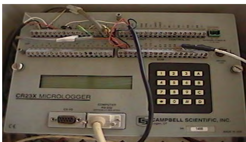
FIGURA 3. Sistema de aquisição de dados (“Micrologger”) utilizado no experimento.
