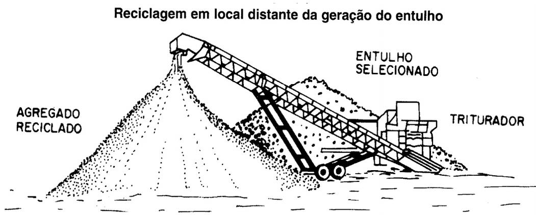
**Figura 4.18** – Esquema de reciclagem na usina de entulho – Fonte: JARDIM et al. (1995)
