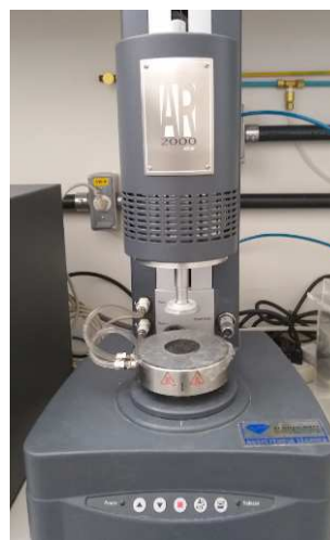
Figura 3.2: (a) agitador mecânico utilizado no preparo das amostras e (b) reômetro AR2000 com geometria de placas paralelas. Fonte: a autora.
