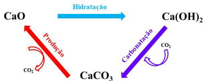
Figura 1.4: Ciclo do \text{CO}_2 liberado na produção do cimento e reabsorvido com a carbonatação. Fonte: adaptado de Scrivener et al. 7 .
