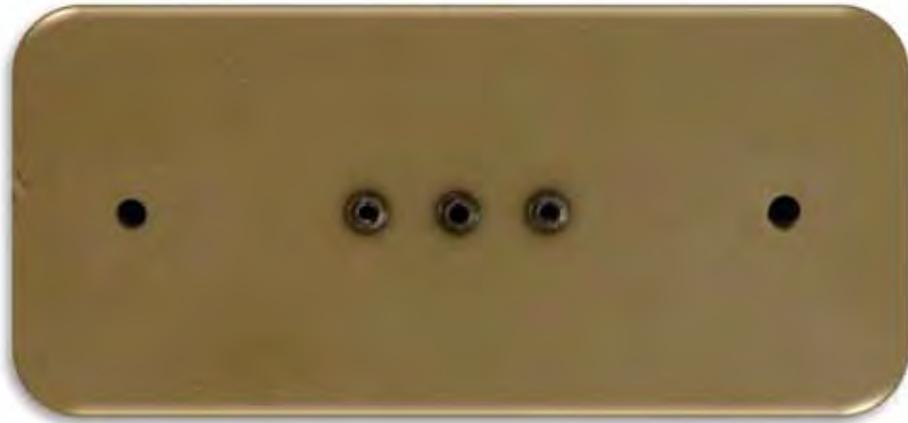
Figura 7 – Posicionamento das fixações de hexágono externo, evidenciando a equidistância e a configuração linear
