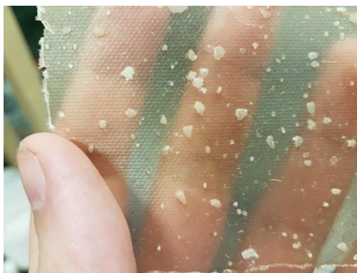
Figura 12 - Filmes contendo MGAE, mostrando a agregação do polímero no material.
