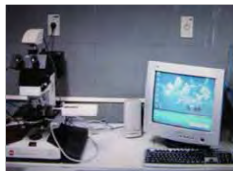
Figura 4. Microscópio óptico acoplado a câmera de captura de imagens conectada ao computador.
