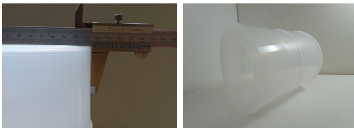
Figura 28: Determinação dos volumes V 1 e V 2 do recipiente Marinelli e forma vazada.
