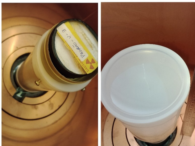
Figura 31: Comparação entre os recipientes de armazenamento dos padrões e frasco Marinelli nas medidas com o detector HPGe.
