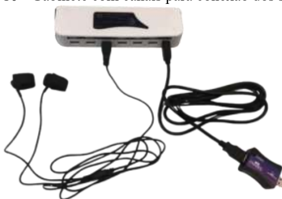
Figura 10 - Gabinete com canais para conexão dos sensores
