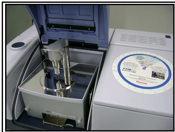
Figura 12 - Equipamento de FTIR Bruker-Tensor 27 com acessório ATR
