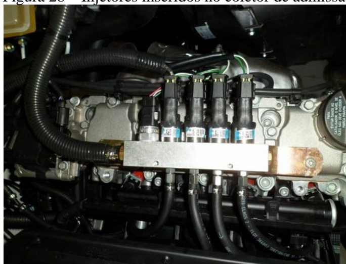
Figura 28 – Injetores inseridos no coletor de admissão
