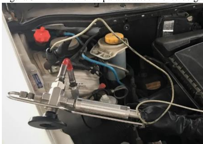
Figura 32 – Aterramento para abastecimento de gás
