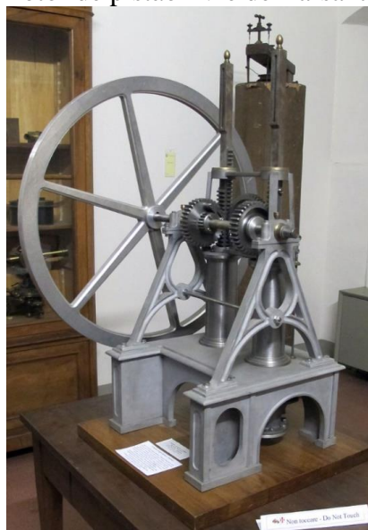
Figura 1 – Motor de pistão livre de Barsanti e Matteuci.
