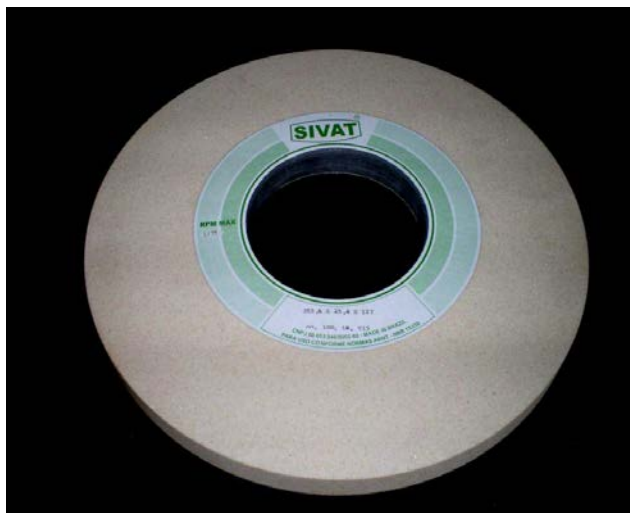
Figura 10 - Rebolo de óxido de alumínio utilizado nos ensaios.
