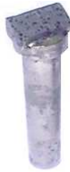
Figura 15 - Dressador multigranular do tipo conglomerado utilizado nos ensaios.
