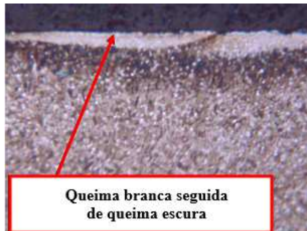
Figura 4 - Exemplo de queima de retificação (aço ABNT 52100 apresentando queimas após a retificação com abrasivo convencional (1000 X)).
