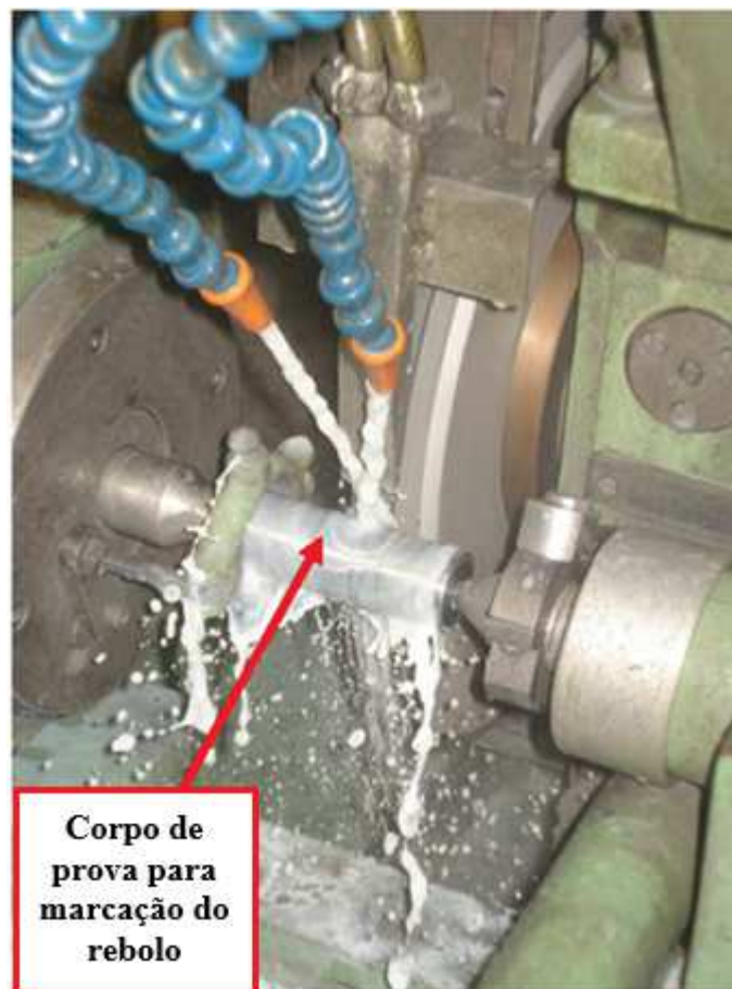
Figura 20 - Processo de marcação do rebolo.
