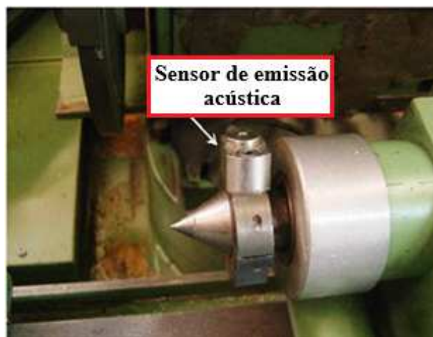
Figura 18 - Sensor fixo de emissão acústica, posicionado no cabeçote móvel
