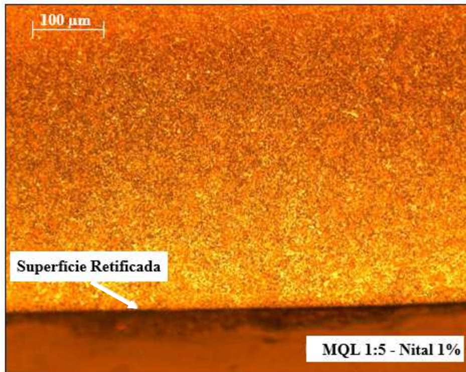
Figura 36 - Metalografia de corpos de prova. Nital 1%. Método MQL 1:5.
