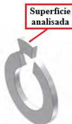
Figura 22 - Amostras retiradas para a análise metalográfica e de microdureza.
