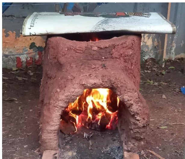
Figura 72 - Forno na fase final da queima.
